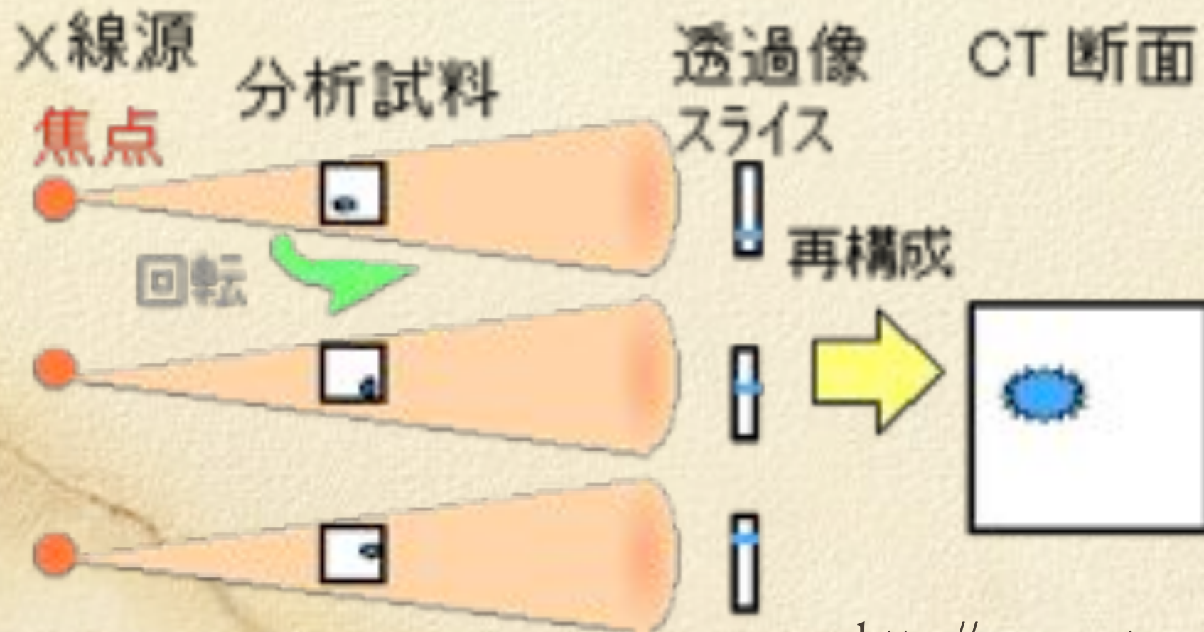
図2 CT断面撮影の原理図
